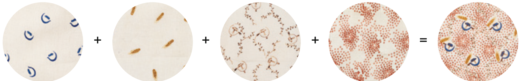
Технологический процесс печати многоцветного рисунка с разбивкой по валам: ситец «Серп и молот». Художник С.П. Бурылин, 1928. Аналог: Кат. 039 Т.
