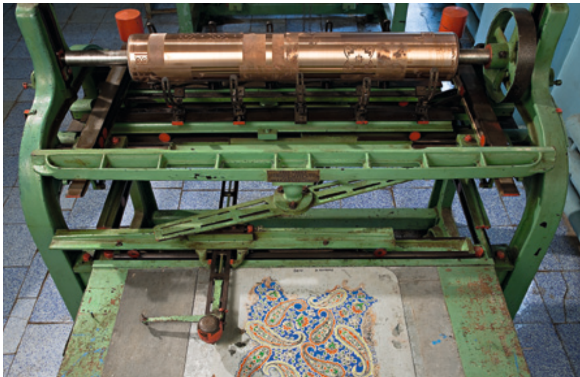
Пантограф фирмы «Lockett, Leake & Co» (Великобритания, после 1873). Использовался на Ивановском хлопчатобумажном комбинате им. Ф.Н. Самойлова.
